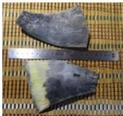
1. Использован способ полного продольного распила рога с последующим разогревом на открытом огне и выпрямлением в прессе
