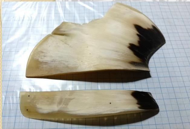
2. С помощью круглого шила сделали на роговой заготовке разметку корпуса варгана.
